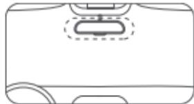
Nota: Asegúrese de colocar la pegatina electrostática en una parte llana y lisa del parabrisas, presiónela con firmeza y evite pegarla en el extremo del film del parabrisas para evitar que se caiga.
