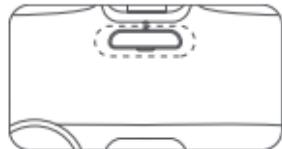
Remarque : veillez à coller l'autocollant électrostatique sur une partie plate et lisse du pare-brise, appuyez fermement dessus et évitez de le coller sur le bord du film du pare-brise pour éviter qu'il ne tombe.
