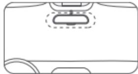
Uwaga: Pamiętaj, aby nakleić naklejkę elektrostatyczną na płaską i gładką część szyby, mocno ją dociśnij i unikaj przyklejania jej na krawędzi folii szyby, aby nie spadła.
