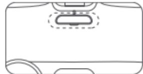
Poznámka: Elektrostatickou nálepku nalepte na rovnou a hladkou část čelního skla, pevně ji přitlačte a nelepte ji na okraj fólie čelního skla, aby nespadla.
