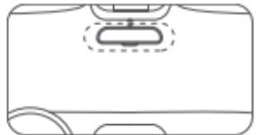
注意：確保將靜電貼黏貼在擋風玻璃平整光滑的部位，用力按壓，且避免黏貼在擋風玻璃的薄膜邊緣，以防止靜電貼脫落。
