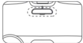
Nota: Cole o autocolante eletrostático numa parte plana e lisa do para-brisa, pressione-o com firmeza e evite que fique preso na extremidade da película do para-brisa para evitar que caia.
